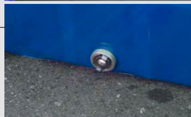
Mogelijkheid om de bak te voorzien van afvoeroening en kogelkraan
